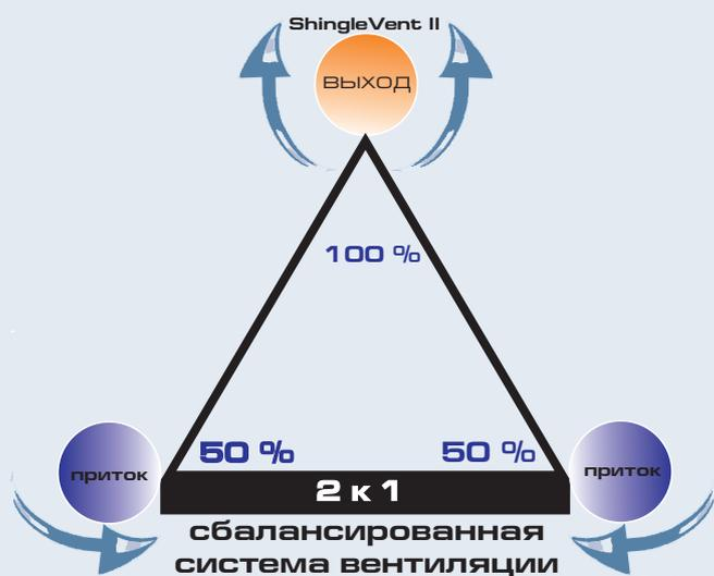
**ShingleVent II**, является неотъемлемой частью сбалансированной системы вентиляции, которая обеспечивает стабильное и непрерывное движение воздушного потока в подкровельном пространстве на протяжении всего срока эксплуатации здания.
