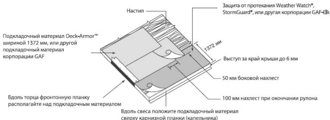
Минимальный уклон кровли 18°. Для более низких уклонов см. Пункт 1а.
