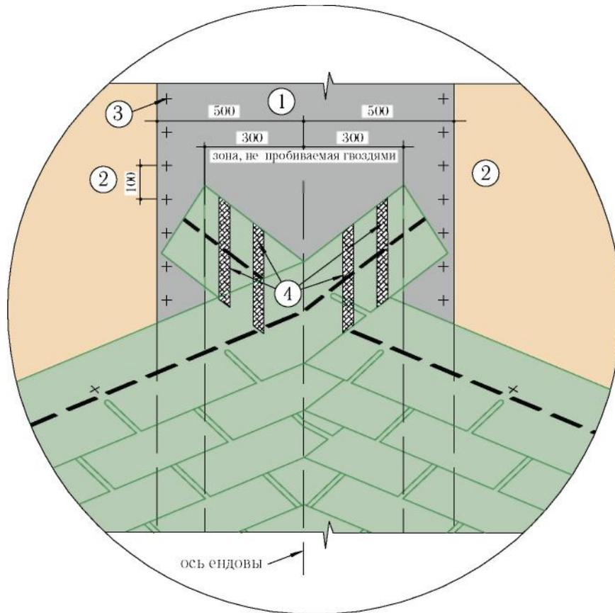
Этот способ укладки ендовы может применяться ТОЛЬКО при равенстве уклонов скатов, образующих ендову;
